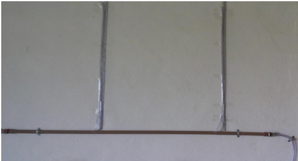
Figura 10: Tubo de Pitot composto por tubulação transversal de diâmetro de \frac{3}{4} " e mangueiras verticais acompanhadas de réguas milimetradas
